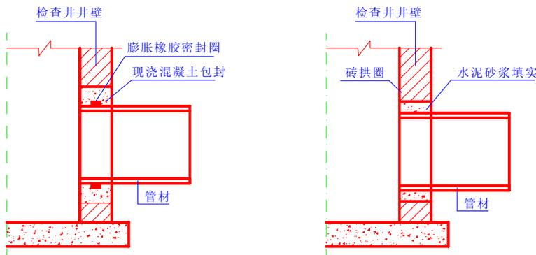
图7.0.2 现浇混凝土包封连接 图7.0.3 管道与检查井预留洞的连接
