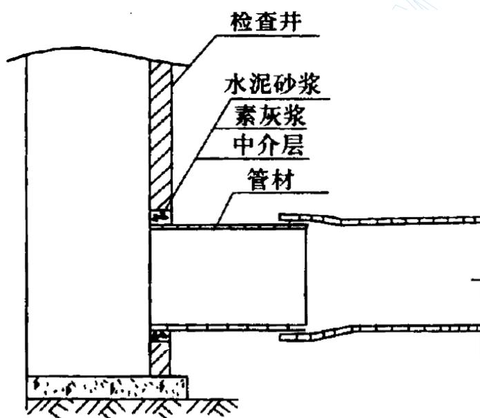
图 7.0.2 管道与检查井的连接（一）
