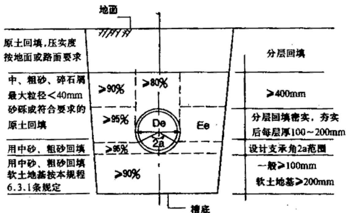
图 8.2.5 沟槽回填土要求
