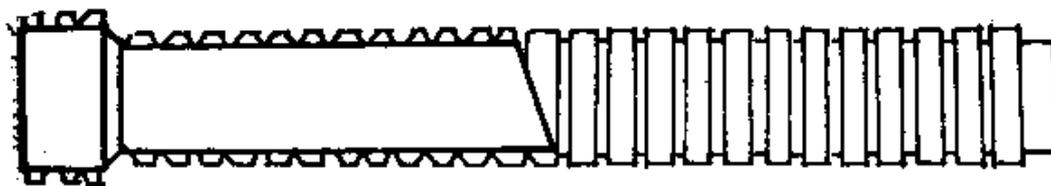
图 A-3 螺旋肋管
