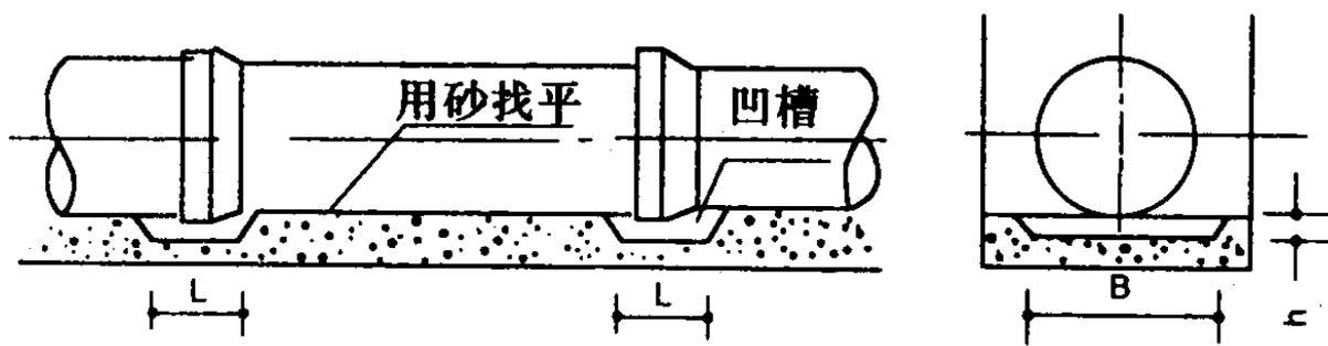
图 6.3.4 管道接口处的凹槽
