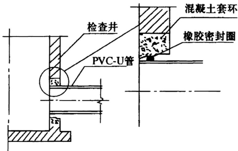
图 7.0.3 管道与检查井的连接 (二)
